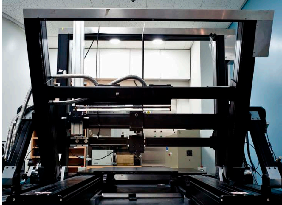
2~100 \mu\text{m} 까지 이미지를 획득할 수 있는 고정밀 측정 장비 E-VIMS
